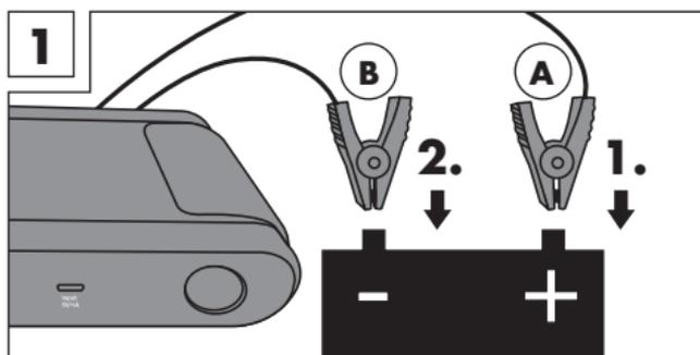
**⚠ AVERTISSEMENT** Dès que le véhicule est démarré, débrancher dans les 30 secondes le câble d'assistance au démarrage **10** de l'aide au démarrage mobile pour voitures avec batterie externe Powerbank **1**. Débrancher d'abord la borne noire puis la borne rouge des pôles de la batterie. Dans le cas contraire, des situations dangereuses pourraient se produire ! Laisser tourner le moteur du véhicule.
