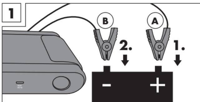
**⚠️ WARNUNG!** Sobald das Fahrzeug gestartet ist, innerhalb von 30 Sekunden das Starthilfekabel **10** von der mobilen Autostarhilfe mit Powerbank **1** entfernen und zuerst die schwarze und dann die rote Batterieklemme von den Batteriepolen abklemmen. Ansonsten kann es zu gefährlichen Situationen kommen! Den Motor des Fahrzeugs laufen lassen.
