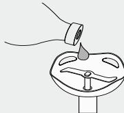
Pokud se během provozu ozývají neobvyklé zvuky, jako je pískání apod., pak hnací hřidel tyčového mixéru ⑤ namažte trochu neutrálního stolního oleje.
