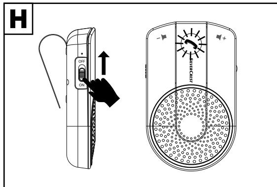
Urządzenie przełączy się na tryb parowania i jest gotowe do połączenia z urządzeniem zewnętrznym za pośrednictwem Bluetooth®. Przycisk telefonu (2) migaj w szybkim tempie w kolorze niebieskim.
