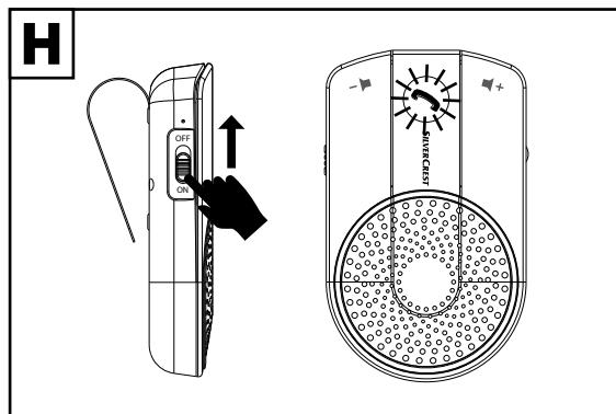
Udstyret skifter til parringsfunktionen og er klar til at blive forbundet med en ekstern enhed via Bluetooth®. Telefonknappen (2) blinker hurtigt blåt.
