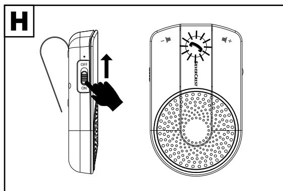
Zařízení se přepne do režimu párování a je připraveno ke spojení s externím zařízením přes Bluetooth®. Tlačítko telefonu (2) bliká rychle modře.
