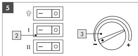
**HINWEIS!** Dank des automatischen Betriebs hält die Heißluftsteuerung (Thermostat) die eingestellte Temperatur konstant.
