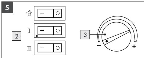
**INSTRUCTIE!** Dankzij de automatische werking houdt de heteluchtbesturing (thermostaat) de ingestelde temperatuur constant.
