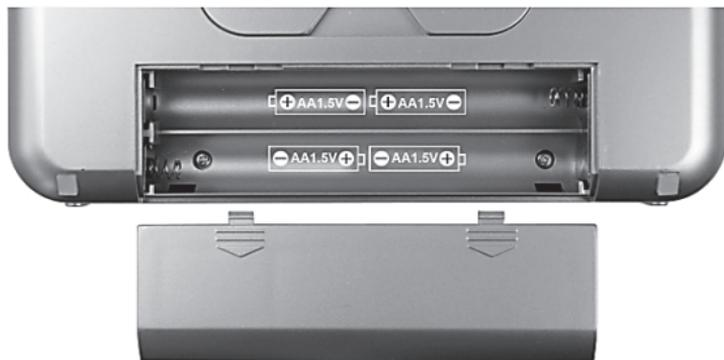
Wenn Ihnen im Display (6) ein niedriger Batteriestand (38) signalisiert wird, sind die Batterien fast verbraucht. Tauschen Sie diese dann gegen neue Batterien gleichen Typs aus.
