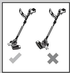
Lorsque vous réglez les positions de travail, veillez à être protégé du dispositif de coupe par le capot de protection **9**.
