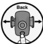
Drücken Sie die Taste **PRESS 7** an der Geräterückseite und die Haltebacken ⑥ der KFZ-Halterung fahren automatisch nach außen.
