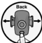
Appuyez sur la touche **PRESS** ⑦ au dos de l'appareil et les mâchoires de fixation ⑥ du support véhicule sortent automatiquement.
