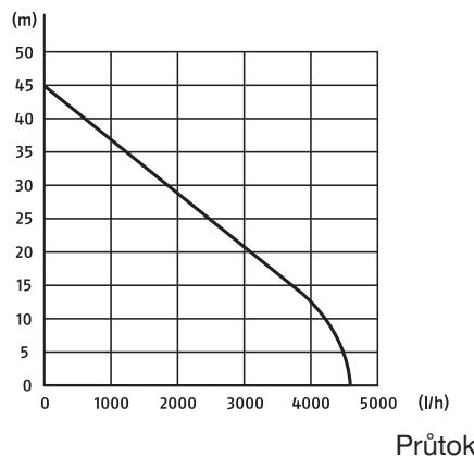
Měření dat maximálního výkonu probíhá za optimálních podmínek (např. při rovnějším, přímějším výstupu. Užší hadice mohou snížit výkon.
