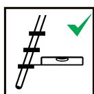
**DE** **AT** **CH** Anlegeleitern mit Stufen müssen so verwendet werden, dass die Stufen sich in horizontaler Lage befinden.
