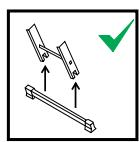
**DE** **AT** **CH** Wenn eine Leiter mit Stabilisierungstraversen geliefert wird und diese Traversen vor der ersten Verwendung durch den Benutzer angebracht werden sollten, muss dies auf der Leiter und in der Gebrauchsanleitung angegeben werden.
