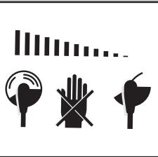
Nach dem Ausschalten des Produkts dreht sich die Schneideeinrichtung noch für einige Sekunden. Halten Sie Hände und Füße in sicherem Abstand.
