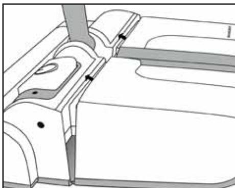
— Glissez le bac à poussière **10** dans l'appareil à l'aide d'un léger mouvement de basculement. Veillez bien à ce que le bac à poussière **10** s'enclenche sur le bouton de déverrouillage **11**.
