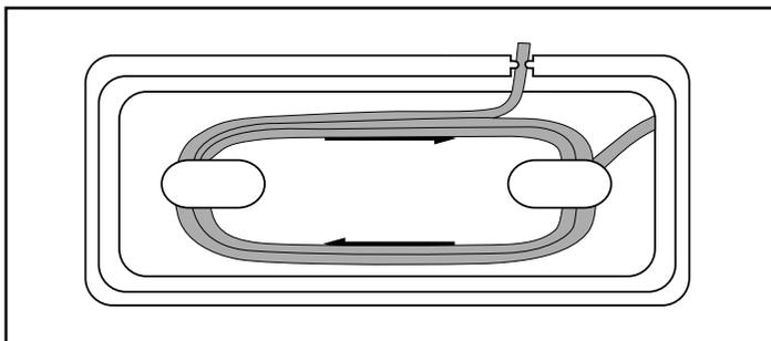
Tým zabránite zalomeniu, znečisteniu kábla a tomu, aby bol zdrojom nebezpečenstva, keď voľne visí:
