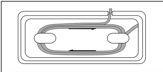
Ezáltal elkerülhető, hogy a hálózati vezeték beszoruljon, beszennyeződjön vagy rögzítés nélkül leölgva veszélyforrássá váljon.
