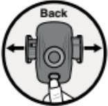
Stiskněte tlačítko **PRESS** ⑦ na zadní straně přístroje a čelisti držáku ⑥ do motorových vozidel se automaticky vysunou ven.
