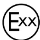
Az E-jelzés a járműveken használt engedélyt igénylő szerkezeti elemet ismertetőjele és azt mutatja, hogy a szükséges vizsgálatokat végrehajtották és kiadták az ECE-gyártási engedélyt. Az „xx” betűk helykitöltők és azt az országot jelölik, amelyikben az engedélyt kiállították.
