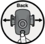
Drücken Sie die Taste **PRESS 7** an der Geräterückseite und die Haltebacken **6** der KFZ-Halterung fahren automatisch nach außen.
