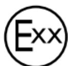
Marcajul E este un marcaj de verificare pentru marcarea componentelor omologate la autovehicule și precizează că au fost efectuate verificările necesare și că a fost acordată o omologare de tip ECE. Grupul de litere „xx” este substituent și reprezintă țara emitentă a omologării.
