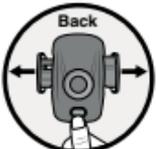
Apăsați tasta **PRESS** ❺ de pe partea posterioară a aparatului și clemele de prindere ❻ ale suportului auto se vor deplasa automat spre exterior.
