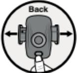
Stlačte tlačidlo **PRESS** ⑦ na zadnej strane prístroja a prídržné čeluste ⑥ automobilového držiaka sa presunú automaticky von.
