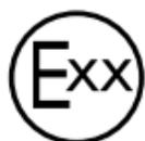
Značka E je kontrolná značka na označenie konštrukčných dielov na motorových vozidlách s povinnosťou schválenia a oznamuje, že boli vykonané potrebné skúšky a bolo udelené schválenie ECE konštrukčného typu. Písmená „xx“ sú skratky pre krajinu, v ktorej bolo schválenie vydané.
