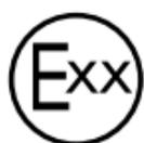
Das E-Kennzeichen ist ein Prüfzeichen für die Kennzeichnung von genehmigungspflichtigen Bauteilen an Kraftfahrzeugen und besagt, dass die erforderlichen Prüfungen durchgeführt wurden und eine ECE-Bauartgenehmigung erteilt wurde. Die Buchstaben „xx“ sind Platzhalter und stehen für das Land, in dem die Zulassung ausgestellt wurde.
