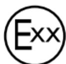
Le label E est une marque d'homologation désignant des composants véhicule qui nécessitent une approbation ; il indique que les vérifications nécessaires ont été réalisées et qu'une homologation ECE du type a été délivrée.
