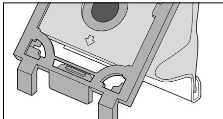
2. Insérez le support de sac à poussière avec le sac à poussière par le haut dans les deux rails dans l'aspirateur. Assurez-vous que le sac à poussière n'est coincé nulle part.
