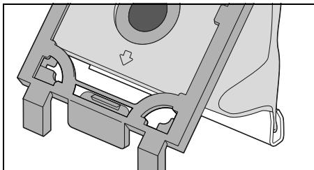
2. Schieben Sie die Staubbeutel-Halterung mit Staubbeutel von oben in die beiden Schienen im Staubsauger. Achten Sie darauf, dass der Staubbeutel dabei nirgends eingeklemmt wird.
