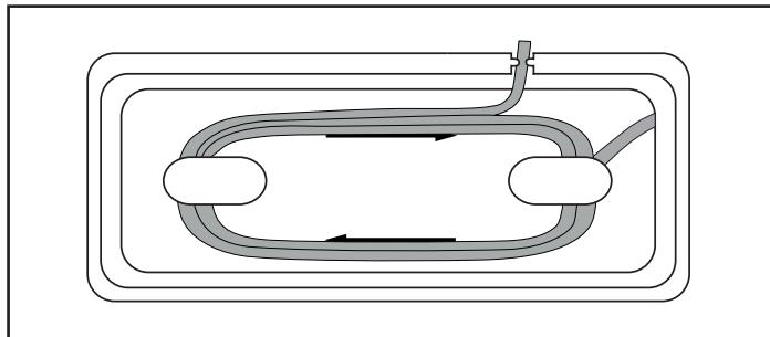
Tak zabráníte tomu, aby byl síťový kabel uskřípnut či znečištěn nebo aby se volně visící kabel stal zdrojem nebezpečí:
