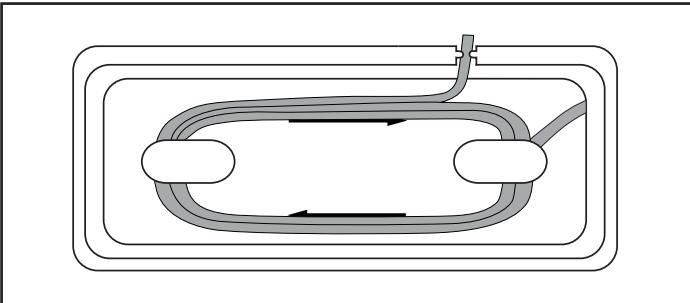
Tým zabráňte zalomeniu, znečisteniu kábla a tomu, aby bol zdrojom nebezpečenstva, keď voľne visí:
