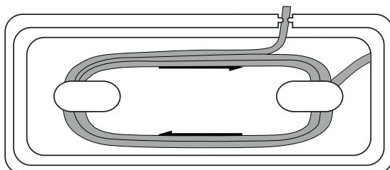
Ezáltal elkerülhető, hogy a hálózati vezeték beszoruljon, beszenyeződjön vagy rögzítés nélkül lelógva veszélyforrássá váljon.
