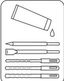
Fetten Sie das Einsteckende des Einsatzwerkzeugs vor dem Einsetzen in die Werkzeugaufnahme ⑨ mit dem mitgelieferten Fett ⑰ leicht ein.
