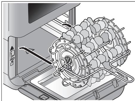
7. Wenn alle Kebapspieße **15** befestigt sind, setzen Sie das Kebapspießrad mit Hilfe des Griffes **11** in das Gerät **1** ein.
