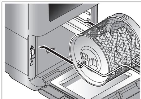
5. Zatvorený otočný kôš **12** nasadíte pomocou rukoväte **11** do prístroja **1** (pozri „Vloženie otočného koša/otočného ražňa“ na strane 16).
