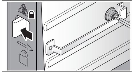
3. Lassen Sie die Entriegelungstaste **4** los, um den Drehkorb **12** / Drehspieß **10** auf der linken Seite zu verriegeln. Der Vierkant muss noch nicht genau passen. Wenn die Rotationsfunktion anläuft, positioniert der Vierkant sich automatisch richtig.
