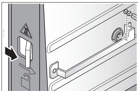
2. Stlačte odblokovacie tlačidlo **4** doprava a zavesíte otočný kôš **12** / otočný ražeň **10** na ľavej strane.
