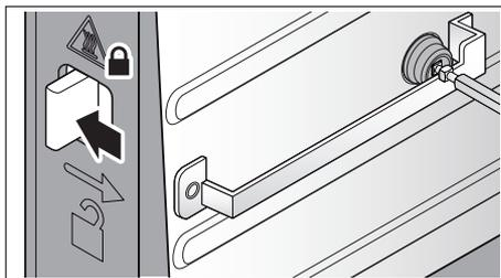
3. Pustíte odblokovacie tlačidlo **4**, aby ste mohli otočný kôš **12** / otočný ražeň **10** zaistiť na ľavej strane. Štvorhran ešte nemusí presne sedieť. Keď sa funkcia otáčania rozbehne, umiestni sa štvorhran automaticky správne.
