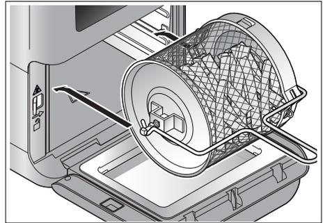
5. Den verschlossenen Drehkorb **12** setzen Sie mit Hilfe des Griffes **11** in das Gerät **1** ein (siehe "Drehkorb/Drehspieß einsetzen" auf Seite 40).
