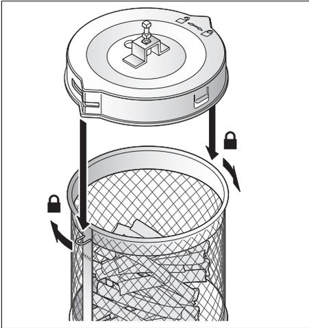
3. Setzen Sie den Deckel **14** auf den Drehkorb **12**. Die Ausbuchtungen am Deckel müssen dabei über die kleinen Ösen am Korb gesetzt werden (siehe Abbildung).
