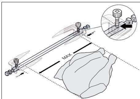
Die Markierungen **9** kennzeichnen die äußersten Positionen, wo die Feststellschrauben **7** befestigt werden dürfen. Die maximale Länge des Hähnchens oder Bratenstückes ist etwas kleiner.
