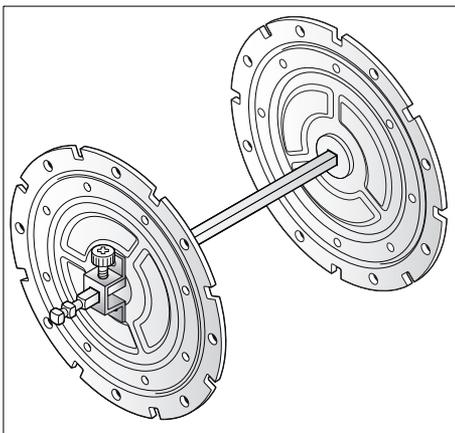
2. Befestigen Sie die beiden Haltescheiben **16** an den Enden des Drehspießes **10**. Die Feststellschrauben **7** müssen dabei genau auf die Markierungen **9** geschraubt werden.
