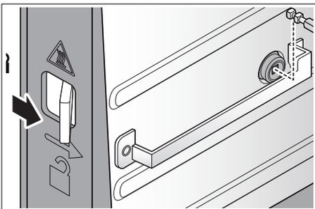
2. Drücken Sie die Entriegelungstaste **4** nach rechts und hängen den Drehkorb **12** / Drehspieß **10** auf der linken Seite ein.
