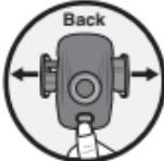
Stlačte tlačidlo **PRESS 7** na zadnej strane prístroja a prídružné čeľuste **6** automobilového držiaka sa presunú automaticky von.
