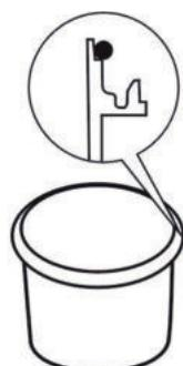
**! UPOZORNĚNÍ:** Nasadte velké gumové těsnění na horní okraj filtrační nádoby **6** (viz obr. vlevo). Dbejte na to, aby se při zavírání víka neposunulo. V případě potřeby můžete těsnění dodatečně navlhčit.
