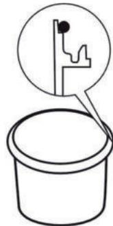
**OPMERKING:** Plaats de grote rubber pakking aan de bovenkant van het filtervat **6** (zie afb. links). Let erop dat deze niet verschuift wanneer u de deksel sluit. Eventueel kunt u de pakking extra bevochtigen.
