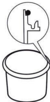
**!** **ÚTMUTATÁS:** Helyezze a nagy gumitömítést a szűrőtartály **[6]** felső peremére (lásd a bal oldali ábrán). Ügyeljen arra, hogy a fedél zárasa közben ne mozduljon el. Szükség esetén nedvesítse meg a tömítést.
