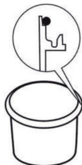
**!** **REMARQUE :** Placez le grand joint en caoutchouc sur le bord supérieur du boîtier du filtre **6** (cf. fig. à gauche). Veillez à ce que ce dernier ne se déplace pas lorsque vous fermez le couvercle. Vous pouvez, si nécessaire, humidifier le joint.
