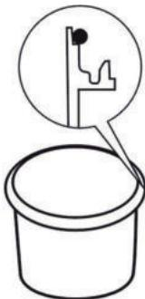
**Hinweis:** Platzieren Sie die große Gummidichtung an der oberen Kante der Filtertonne **6** (siehe Abb. links). Achten Sie darauf, dass diese sich nicht verschiebt, während Sie den Deckel verschließen. Ggf. können Sie die Dichtung zusätzlich anfeuchten.
