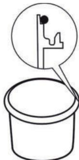
**! UPOZORNENIE:** Vložte veľké gumové tesnenie na horný okraj filtračnej nádoby **6** (pozri obr. vľavo). Dbajte na to, aby sa neposunulo pri zatváraní krytu. Prípadne môžete tesnenie dodatočne navlhčiť.
