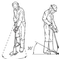
1. Schneiden Sie Gras, indem Sie das Gerät nach rechts und links schwenken.
