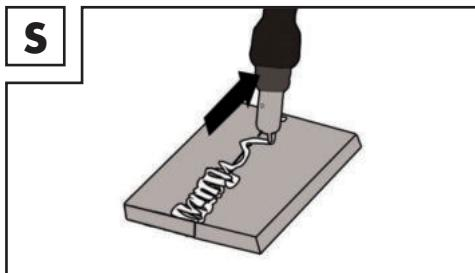
Ahhoz, hogy megelőzhetők vagy csökkenthetők legyenek az anyag keményedése során bekövetkező deformálódások, célszerű valamilyen eszközzel rögzíteni a munkadarabokat. El kell kerülni a hegesztett struktúra megmerevedését, hogy megakadályozhatók legyenek a hegesztési törések. Ezek a nehézségek csökkenthetők, ha úgy lehet elforgatni a munkadarabot, hogy a hegesztést két szemközti irányú menetben lehessen elvégezni.
