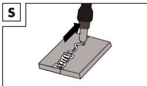
K zamezení nebo redukci deformací vznikajících během tvrdnutí materiálu je dobré obrobky před svařováním upevnit do přípravku. Musí se zamezit vyztužení svařované struktury, aby nedocházelo k prasknutí svaru. Tyto obtíže lze redukovat, pokud existuje možnost obrobek otočit tak, aby bylo možno svařování provést ve dvou krocích protichůdným směrem.
