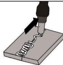
Per prevenire o ridurre le deformazioni che possono verificarsi durante l'indurimento del materiale, è opportuno fissare i pezzi da saldare con un dispositivo. La struttura saldata non va irrigidita, in modo da evitare fratture nella saldatura. Tali difficoltà possono essere ridotte se è possibile ruotare il pezzo da saldare in modo che la saldatura possa essere eseguita in due passaggi opposti.
