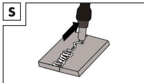
Um Verformungen, die während der Materialhärtung eintreten können, zu verhindern oder zu verringern, ist es gut, die Werkstücke mit einer Vorrichtung zu fixieren. Es ist zu vermeiden, die verschweißte Struktur zu verstiften, damit Brüche in der Schweißung vermieden werden. Diese Schwierigkeiten können verringert werden, wenn die Möglichkeit besteht, das Werkstück so zu drehen, dass die Schweißung in zwei entgegengesetzten Durchgängen durchgeführt werden kann.
