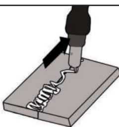
For at komme deformeringer, der kan opstå, når materialet hærdner, i forkøbet eller for at forringe dem er det godt at fiksere emnerne med en indretning. Det skal undgås at stivgøre den sammensvædede struktur, så brud i svejsningen tilsvarende undgås. Disse vanskeligheder kan reduceres, når der er mulighed for at dreje emnet, således at svejsningen kan gennemføres i to modsat rettede
