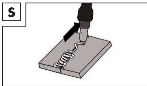
Na redukciu deformácie obrobkov počas tvrdnutia materiálu je potrebné tam, kde je to možné, zafixovať obrobky príslušným prípravkom. Je treba zabrániť pnutiu zváranej štruktúry, aby nedochádzalo k praskaniu zvarov. Tieto problémy je možné redukovať, pokiaľ je to možné, otáčaním obrobku, aby sa dalo zváranie vykonávať v dvoch protichodných smeroch.
