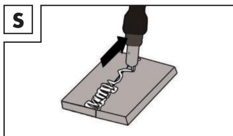
Om vervormingen die tijdens de materiaalbehandeling kunnen optreden, te voorkomen of te beperken, is het goed om de werkstukken met een voorziening vast te zetten. Het dient te worden vermeden om de gelaste structuur te verstijven, zodat breuken in de las worden vermeden. Deze moeilijkheden kunnen worden beperkt, wanneer de mogelijkheid bestaat om het werkstuk zo te draaien dat de las in twee tegenovergestelde doorvoeren kan worden geleid.
