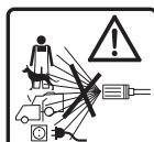
Les nettoyeurs à haute pression peuvent être dangereux en cas d'utilisation impropre. Le jet ne doit pas être dirigé vers des personnes, des animaux, des équipements électriques activés ou l'appareil lui-même.
