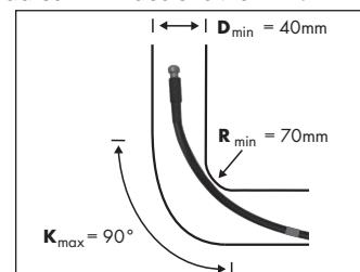
Ausgelegt für einen Arbeits-/ Bemessungsdruck von max. 150 bar.
