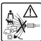
Hochdruckreiniger können bei unsachgemäßem Gebrauch gefährlich sein. Der Strahl darf nicht auf Personen, Tiere, aktive elektrische Ausrüstung oder das Gerät selbst gerichtet werden.
