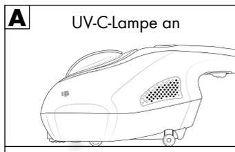
Verlieren die Sicherheitsschalter den Kontakt zum Untergrund, wird die Abschaltautomatik aktiviert und die UV-C-Lampe ❽ hört auf zu leuchten (Abb. B und C).
