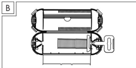
Legen Sie die Aufhängevorrichtung **4** wie in Abb. B zu sehen ein, und schließen Sie die Sicherheitsbox. Verriegeln Sie die Sicherheitsbox zusätzlich mit Hilfe der Verschluss-Clips **1**.
