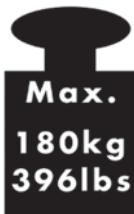
Dette symbol angiver, at diagnosevægten ikke kan klare en vægt på over 180 kg eller 396 lb. I modsat fald kan diagnosevægten gå i stykker, og der er fare for kvæstelser.
