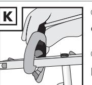
DE AT CH Positionieren Sie das Bördelwerkzeug so, dass die Spitze mittig in das Verrohrungsende eindringt.
