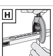
DE AT CH Die Spitze muss auf dem Druckstück zentriert sein. Das Bördelwerkzeug muss an der Verrohrungsklemme verriegelt sein.
