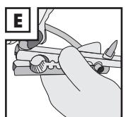
FR CH Serrez l'écrou papillon. Gardez les deux moitiés de la pince de tubage parallèles l'une à l'autre lorsque vous les serrez.
