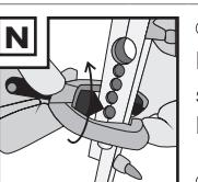
DE AT CH Entnehmen Sie das Bördelwerkzeug. Inspizieren Sie das Verrohrungsende. Die Umbördelung sollte rundum eben sein, ohne Risse oder Lücken. Entnehmen Sie die Verrohrung aus der Klemme.
