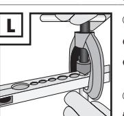
DE AT CH Stellen Sie sicher, dass sich die Spitze mittig auf dem Rohr befindet und dass das Bördelwerkzeug auf der Verrohrungsklemme verriegelt ist.
