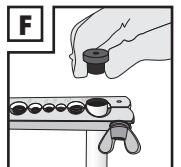
DE AT CH Drehen Sie das Druckstück um. Benetzen Sie das Druckstück mit einer kleinen Menge an Schmiermittel. Stecken Sie das Druckstück in das Rohr.
