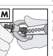
DE AT CH Drehen Sie die Schraube im Uhrzeigersinn und ziehen Sie diese fest, bis der Kegel komplett abgeflacht ist.
