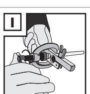
DE AT CH Drehen Sie die Schraube im Uhrzeigersinn, bis sich das Druckstück auf der Verrohrungsklemme abflacht. Das endgültige Anziehen ist einfacher, wenn Sie die Verrohrungsklemme in einen Schraubstock einspannen. Achten Sie darauf, dass das Rohr während der Verwendung nicht herausrutscht.
