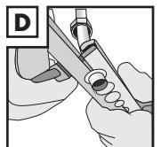
DE AT CH Ziehen Sie die Flügelmuttern fest. Halten Sie die Hälften der Verrohrungsklemme parallel zueinander beim Festziehen.
