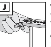
DE AT CH Lösen Sie die Schraube und entnehmen Sie das Druckstück. Das Rohrende sollte zu diesem Zeitpunkt wie eine Blase aussehen.
