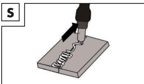
Pour prévenir ou limiter les déformations lors du durcissement du matériau, fixez les pièces à traiter. Évitez de rigidifier la structure soudée pour prévenir les cassures au niveau de la soudure. Vous pouvez réduire ces risques en tournant la pièce à traiter de manière à pouvoir réaliser la soudure en un passage dans chaque sens.
