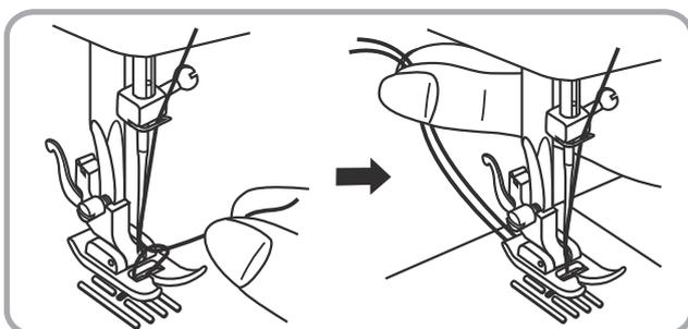
Tirez sur le fil supérieur de manière à faire remonter le fil inférieur à travers l'orifice de la plaque à aiguille. Déposez les deux fils en arrière sous le pied-de-biche (9).
