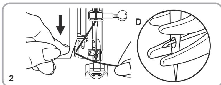
2. Abaissez le levier jusqu'à la butée. L'enfileur d'aiguille tourne automatiquement vers la position d'enfilage et la broche de crochet passe à travers l'œil de l'aiguille (D).
