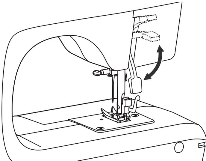
Pour faciliter l'insertion de tissus très épais sous le pied-de-biche (9), on peut augmenter l'espace entre le pied-de-biche et la plaque à aiguille, en relevant le levier du pied-de-biche d'un cran (18) (flèche).
