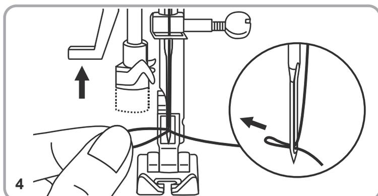
4. Tenez légèrement le fil et relâchez lentement le levier. Le crochet tourne et passe le fil à travers l'œil de l'aiguille formant ainsi une boucle. Tirez le fil à travers l'œil de l'aiguille.
