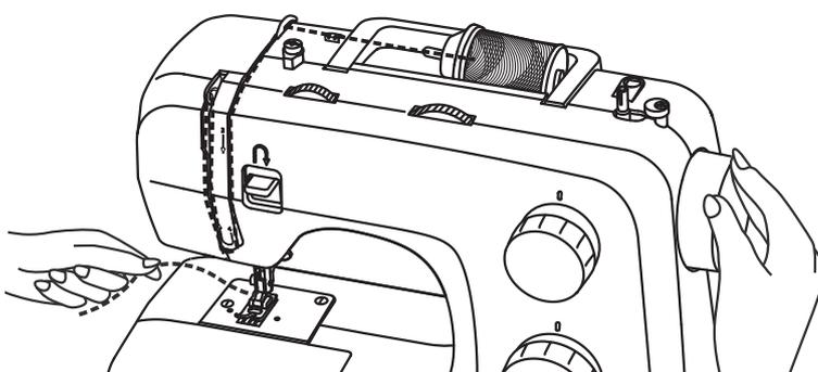
Tenez le fil supérieur avec votre main gauche. Tournez la roue à main (21) dans le sens contraire des aiguilles d'une montre jusqu'à ce que l'aiguille soit complètement remontée (un tour complet).
