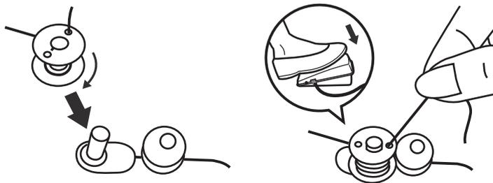
A. Placez la bobine (l) sur le porte-bobine (15) et fixez avec l'arrêt pour bobine (q).
