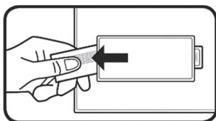
Retirez la bandelette du compartiment des piles (4) situé sous le pèse-personne. Le pèse-personne est désormais prêt à être utilisé.
