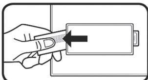
Verwijder de strip uit het batterijvak (4) aan de onderkant van de weegschaal. De weegschaal is nu klaar voor gebruik.
