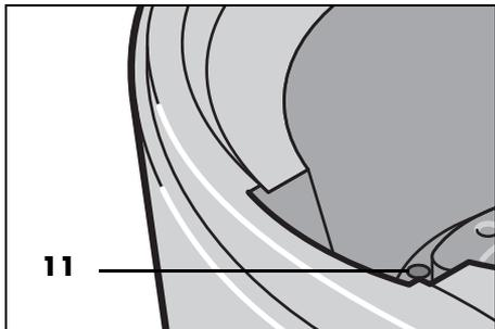
Sollte Flüssigkeit aus dem Mixbehälter **3** austreten, sammelt sich diese nicht im Grundgerät **5**, sondern kann über den Überlauf **11** auf die Arbeitsfläche austreten.
