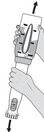
**Wichtig:** Zum Schütteln greifen Sie das Gerät fest an Motorblock (4) und Mixbehälter (8), damit sich das zusammengesetzte Gerät nicht lösen kann.
