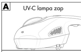
Ak bezpečnostné spínače stratia kontakt s podkladom, aktivuje sa vypínacia automatika a UV-C lampy ⑧ prestane svietiť (obr. B a C).
