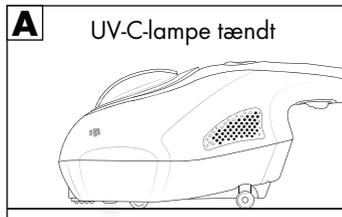
Hvis sikkerhedskontakterne ikke længere rører ved underlaget, aktiveres slukningsmekanismen, og UV-C-lampen ⑧ holder op med at lyse (fig. B og C).
