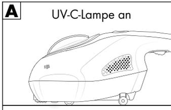
Verlieren die Sicherheitsschalter den Kontakt zum Untergrund, wird die Abschaltautomatik aktiviert und die UV-C-Lampe ③ hört auf zu leuchten (Abb. B und C).
