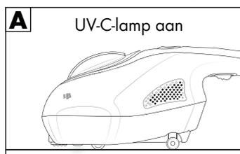
Als de veiligheidsschakelaars het contact met de ondergrond verliezen, wordt de automatische uitschakeling geactiveerd en schakelt de UV-C-lamp 8 uit (afb. B en C).
