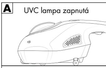
Pokud bezpečnostní spínače ztratí kontakt se zemí, aktivuje se vypínací automatika a UVC lampa ⑧ přestane svítit (obr. B a C).
