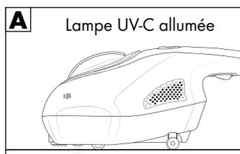
Si les interrupteurs de sécurité ne sont plus en contact avec le support, la coupure automatique est alors activée et la lampe UV-C ❽ n'est plus allumée (Fig. B et C).
