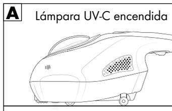
Si los interruptores de seguridad pierden el contacto con la superficie de base, se activa el mecanismo de desconexión automática y la lámpara UV-C ❽ se apaga (fig. B y C).
