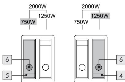
**Upozornění:** Kontrolka [6] aktuálně použitého páčkového přepínače [4] nebo [5] během provozu svítí.
