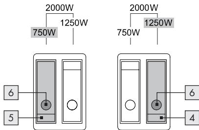
**Aanwijzing:** Als er een tuimelschakelaar **4** of **5** in gebruik is, zal ook het lampje **6** van die schakelaar branden.
