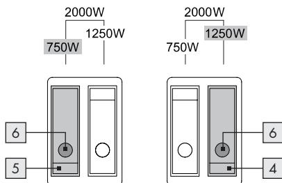
**Nota:** El indicador luminoso **[6]** de cada interruptor **[4]** o **[5]** activado se iluminará durante el funcionamiento.
