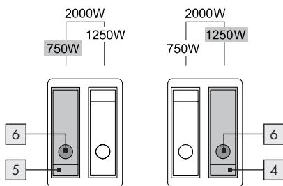
**Remarque :** La lampe **6** de l'interrupteur à bascule **4** ou **5** utilisé s'allume pendant le fonctionnement.
