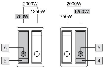
**Wskazówka:** Podczas pracy świeci się dioda [6] odpowiedniegołącznika dźwigienkowego [4] lub [5].
