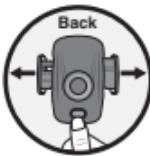
Drücken Sie die Taste **PRESS** ⑦ an der Geräterückseite und die Haltebacken ⑥ der KFZ-Halterung fahren automatisch nach außen.
