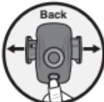
Appuyez sur la touche **PRESS 7** au dos de l'appareil et les mâchoires de fixation **6** du support véhicule sortent automatiquement.
