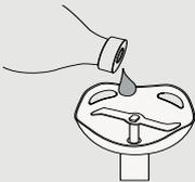
Si, durante el funcionamiento, se aprecian ruidos anómalos, como chirridos o ruidos similares, aplique un poco de aceite de cocina de sabor neutro en el eje de accionamiento del brazo batidor **5**.
