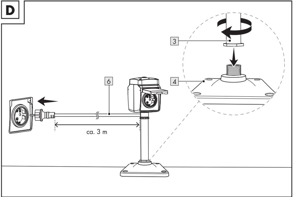
5. Drehen Sie die Stange **3** bis zum Anschlag auf den Fuß **4**.
