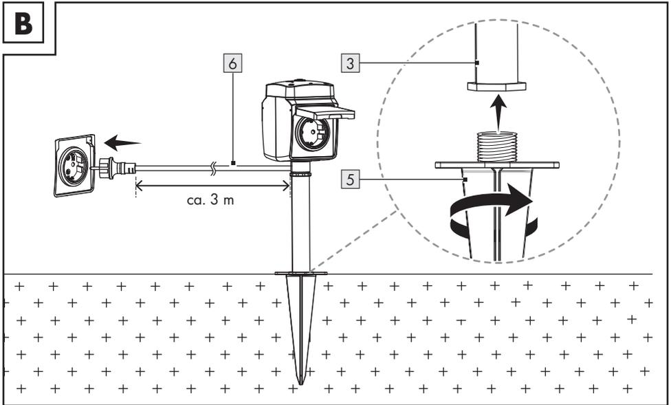
1. Schrauben Sie den Erdspeiß **5** vollständig auf die Stange **3**.
