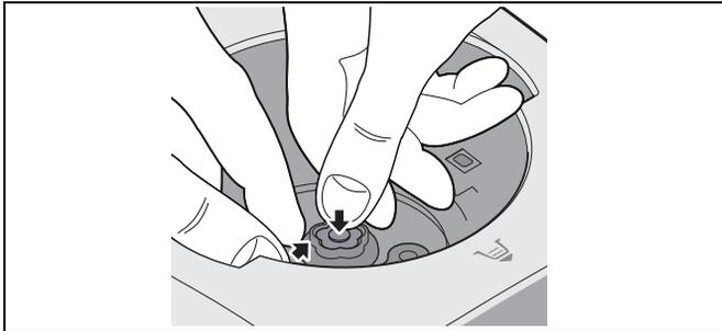
1. Drücken Sie mit dem Daumen auf die Silikon-Abdeckung **26** und greifen Sie gleichzeitig unter den Rand der alten Messeraufnahme **12**. Ziehen Sie die alte Messeraufnahme **12** nach oben heraus. Eventuell müssen Sie ein bisschen „ruckeln“, damit sich die Messeraufnahme **12** herausziehen lässt.
