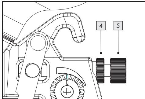
**Conseil :** La vis d'arrêt avant [4] limite la plage de réglage de la vis d'arrêt de course [5].
