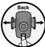
Stiskněte tlačítko **PRESS 7** na zadní straně přístroje a čelisti držáku ⑥ do motorových vozidel se automaticky vysunou ven.
