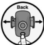
Pulse el botón **PRESS 7** en la parte posterior del aparato y los agarres **6** del soporte para vehículos se moverán automáticamente hacia fuera.
