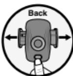
Premere il tasto **PRESS** ⑦ sul retro dell'apparecchio e le ganasce di sostegno ⑥ del supporto auto per cellulare fuoriescono automaticamente.
