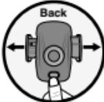
Stlačte tlačidlo **PRESS 7** na zadnej strane prístroja a prídržné čeľuste **6** automobilového držiaka sa presunú automaticky von.
