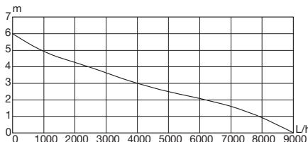
Die Messung der maximalen Leistungsdaten erfolgt bei optimalen Bedingungen (z. B. gerader, direkter Ausgang).
