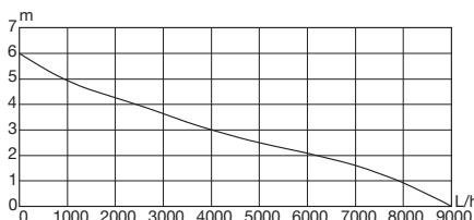
Meranie maximálnych údajov sa vykoná pri optimálnych podmienkach (napr. rovný, priamy výstup).
