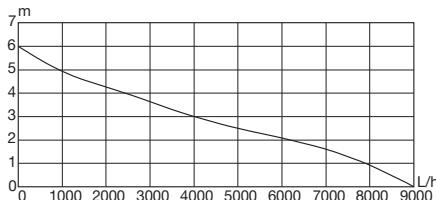
A maximális teljesítményadatok mérése optimális körülmények között történik (pl. egyenes, közvetlen kimenet). Szűkebb tömlők csökkenthetik a teljesítményt.
