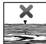
Wenn die Klammeroberseite/der Nagelkopf nicht bündig auf der Oberseite des zu befestigenden Materials aufliegt, haben Sie eine(n) zu lange(n) Klammer/
