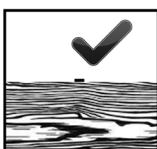
Die Klammeroberseite bzw. der Nagelkopf sollte wie dargestellt bündig auf der Oberseite des zu befestigenden Materials aufliegen.
