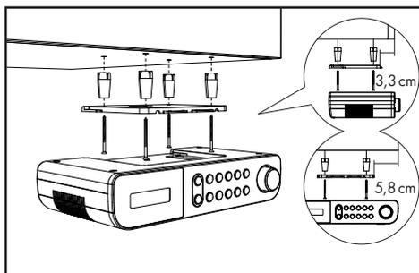
Mit der mitgelieferten Montageplatte **11** können Sie das Produkt z. B. unter einem Hängeschrank installieren. Gehen Sie zur Montage des Produkts wie folgt vor:
