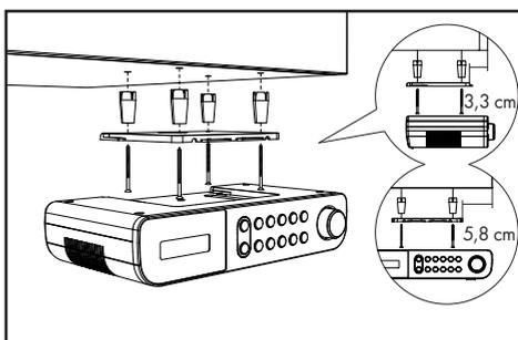
U kunt het product met de meegeleverde montageplaat **11** bijv. onder een hangkast installeren. Ga bij de montage van het product als volgt te werk:
