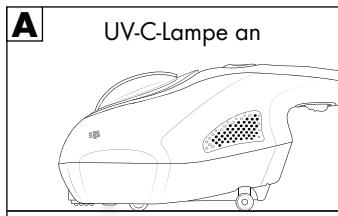
Verlieren die Sicherheitsschalter den Kontakt zum Untergrund, wird die Abschaltautomatik aktiviert und die UV-C-Lampe **8** hört auf zu leuchten (Abb. B und C).
