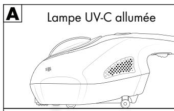
Si les interrupteurs de sécurité ne sont plus en contact avec le support, la coupure automatique est alors activée et la lampe UV-C ⑧ n'est plus allumée (Fig. B et C).
