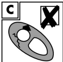
**A nu se mai utilize balansoarul, în cazul în care elementul de fixare prezintă rupturi sau fisuri în urechea de sus (fig. C).**
