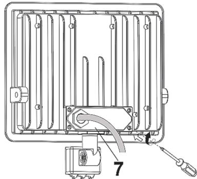
Befestigen Sie nun den LED-Strahler (1) am Montagebügel (9), indem Sie die 2 Schrauben (6) zusammen mit Federring und Unterlegscheibe im Uhrzeigersinn eindrehen. Ziehen Sie die Schrauben (6) zu diesem Zeitpunkt nur leicht an.
