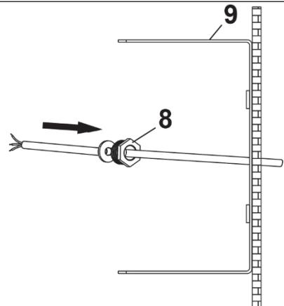
Anschließend führen Sie das Stromkabel, wie in nebenstehender Abbildung gezeigt, durch die Abdeckung des Anschlusskastens (7)
