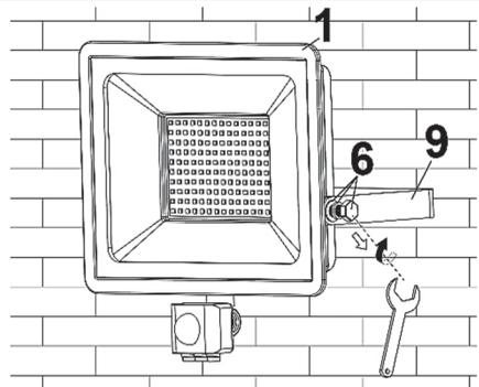
Kippen Sie jetzt den LED-Strahler (1) in die gewünschte Position und ziehen Sie die Schrauben (6) anschließend fest an.
