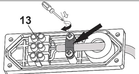
Montieren Sie nun die Stromkabelfixierung (8) und die darunter liegende Dichtung wieder in der Abdeckung des Anschlusskastens (7), indem Sie diese ggf. unter Zuhilfenahme eines passenden Maulschlüssels durch Drehen im Uhrzeigersinn einschrauben und festziehen.
