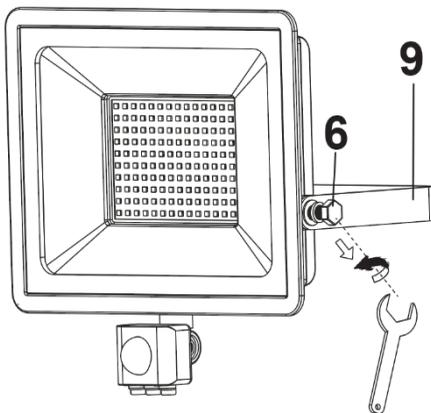
Wählen Sie die Montageposition an der Wand. Nutzen Sie den Montagebügel (9) als Schablone und zeichnen Sie durch die Langlöcher die Position der Bohrlöcher an der Wand an. Führen Sie nun die Wandbohrung durch.
