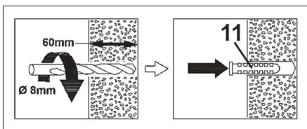
Führen Sie die Dübel (11) in die gebohrten Löcher und schrauben Sie den Montagebügel (9) mit den Schrauben (12) an der Wand fest.
