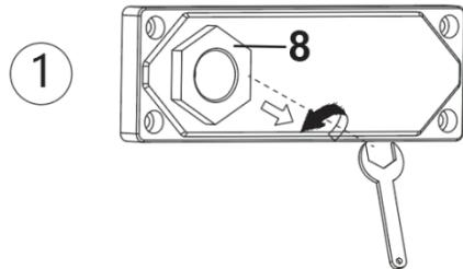
**2.** Entnehmen Sie die Stromkabelfixierung (8) und die darunter liegende Dichtung (Pfeil).
