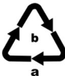
Entsorgen Sie die Verpackung umweltgerecht. Beachten Sie die Kennzeichnung auf den verschiedenen Verpackungsmaterialien und trennen Sie diese gegebenenfalls gesondert. Die Verpackungsmaterialien sind gekennzeichnet mit Abkürzungen (a) und Ziffern (b) mit folgender Bedeutung: 1–7: Kunststoffe, 20–22: Papier und Pappe, 80–98: Verbundstoffe.
