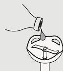
Dacă pe durata funcționării apar zgomote neobișnuite precum scârțâit sau zgomote asemănătoare, aplicați puțin ulei alimentar neutru pe arborele de antrenare al piciorului pasator ④.
