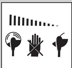
Nach dem Ausschalten des Produkts dreht sich die Schneideeinrichtung noch für einige Sekunden. Halten Sie Hände und Füße in sicherem Abstand.
