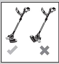
Achten Sie beim Einstellen der Arbeitspositionen darauf, dass Sie durch die Schutzabdeckung 9 vor der Schneideeinrichtung geschützt sind.
