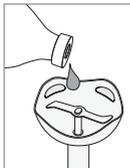
Pokud se během provozu ozývají neobvyklé zvuky, jako je pískání apod., pak hnací hřídel mixovacího nástavce 4 namažte trochou neutrálního stolního oleje.
