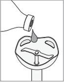
Si en cours de fonctionnement des bruits inhabituels apparaissent tels que des grincements ou autres, appliquez un peu d'huile alimentaire au goût neutre sur l'arbre d'entraînement du mixeur plongeant ④.
