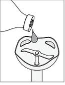
Si, durante el funcionamiento, se aprecian ruidos anómalos, como chirridos o ruidos similares, aplique un poco de aceite de cocina de sabor neutro en el eje de accionamiento del pie de la batidora ④.
