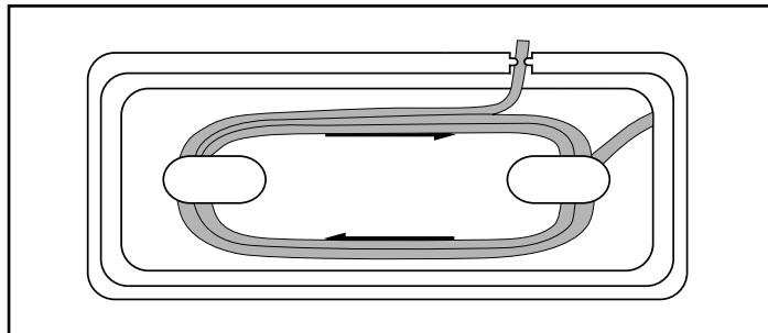
Tým zabráňte zalomeniu, znečisteniu kábla a tomu, aby bol zdrojom nebezpečenstva, keď voľne visí:
