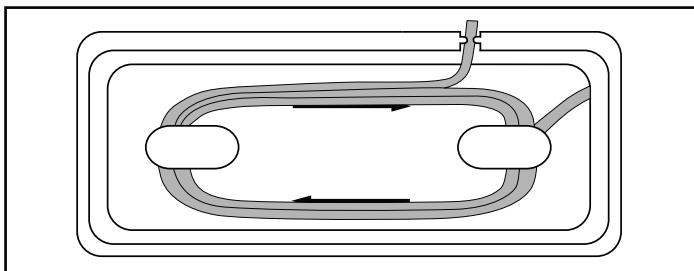
Chroni to przewód przed zaciśnięciem, zabrudzeniem lub niebezpiecznym zwisaniem, co mogłoby być źródłem zagrożenia.
