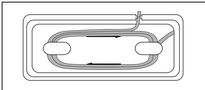
Ezáltal elkerülhető, hogy a hálózati vezeték beszoruljon, beszennyeződjön vagy rögzítés nélkül lelógva veszélyforrássá váljon.
